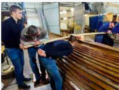
Испытания корпуса композитной шлюпки / Фото: кафедра СМК
