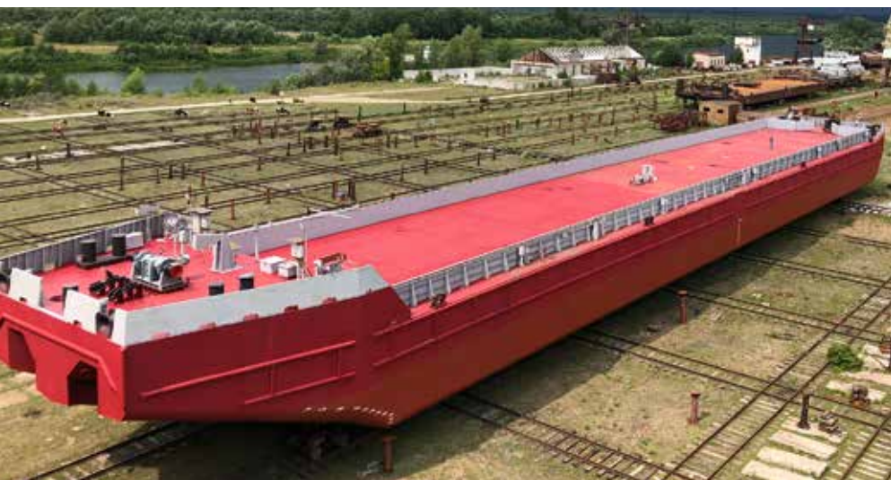
Строительство морской баржи проекта RDB 66.68 класса «М-СП4,5 (лед 40)» для Томской судоходной компании / Фото: ООО «Самусьский судостроительно-судоремонтный завод»
