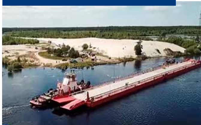
Наплавной мост проекта РЕГК.128 через реку Конда / Фото: ООО «Самусьский судостроительно-судоремонтный завод»
