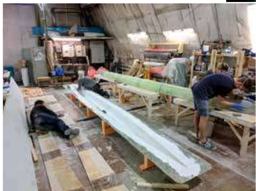
Извлечение корпуса, изготовленного инфузионным формованием, из матрицы / Фото: пресс-служба СПбГМТУ
