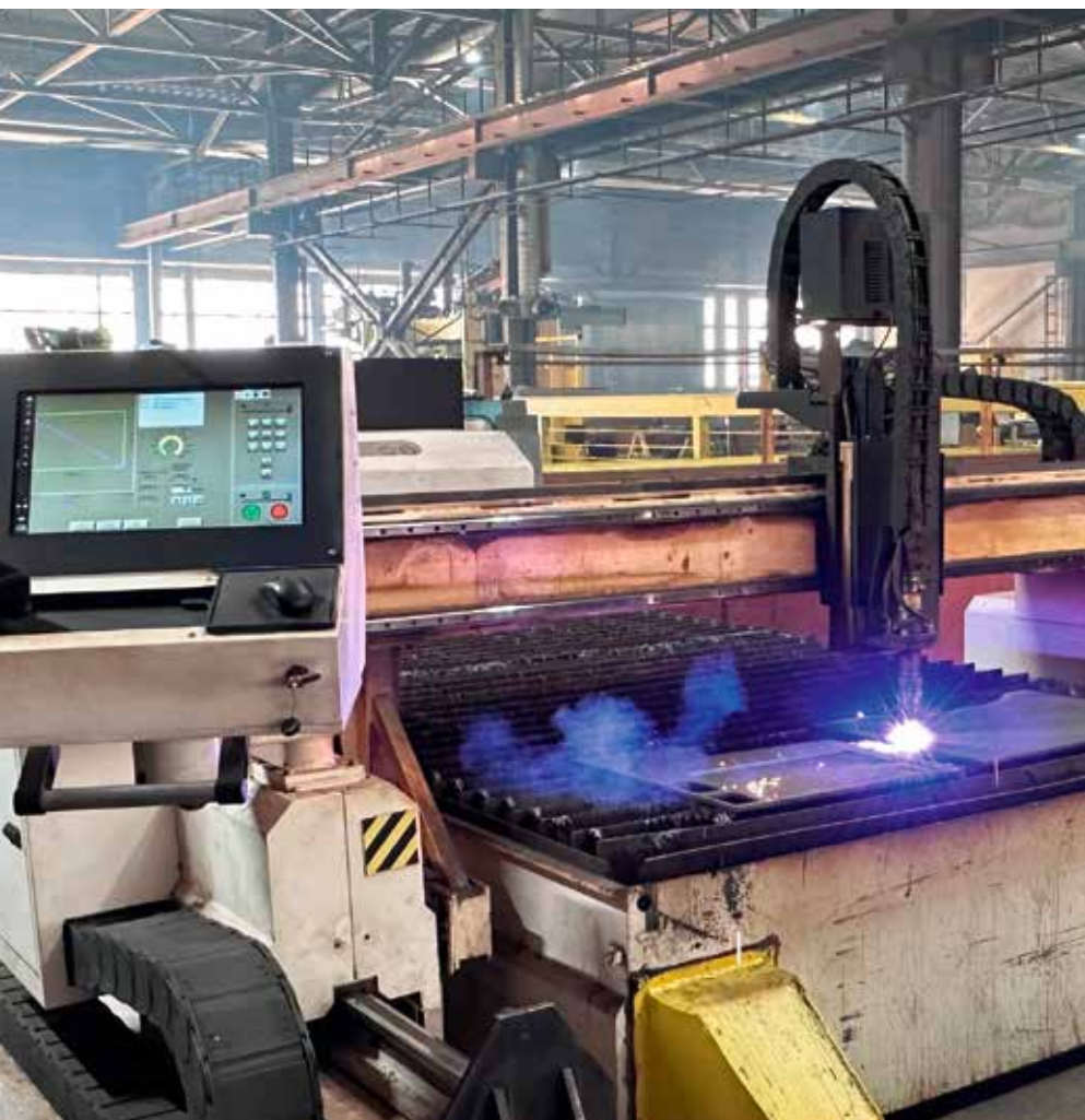
Установка плазменной резки способна работать с металлом толщиной до 25мм / Фото: ООО «Самусьский судостроительно-судоремонтный завод»
